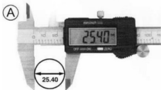
A. Diamètre d'un cylindre : ici d = 25,40 mm Attention : ne pas oublier l'unité !
